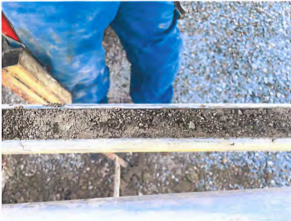
Abb. 8: Erbohrte kiesige Sandschicht (BS 07 – etwa 5,3m)
