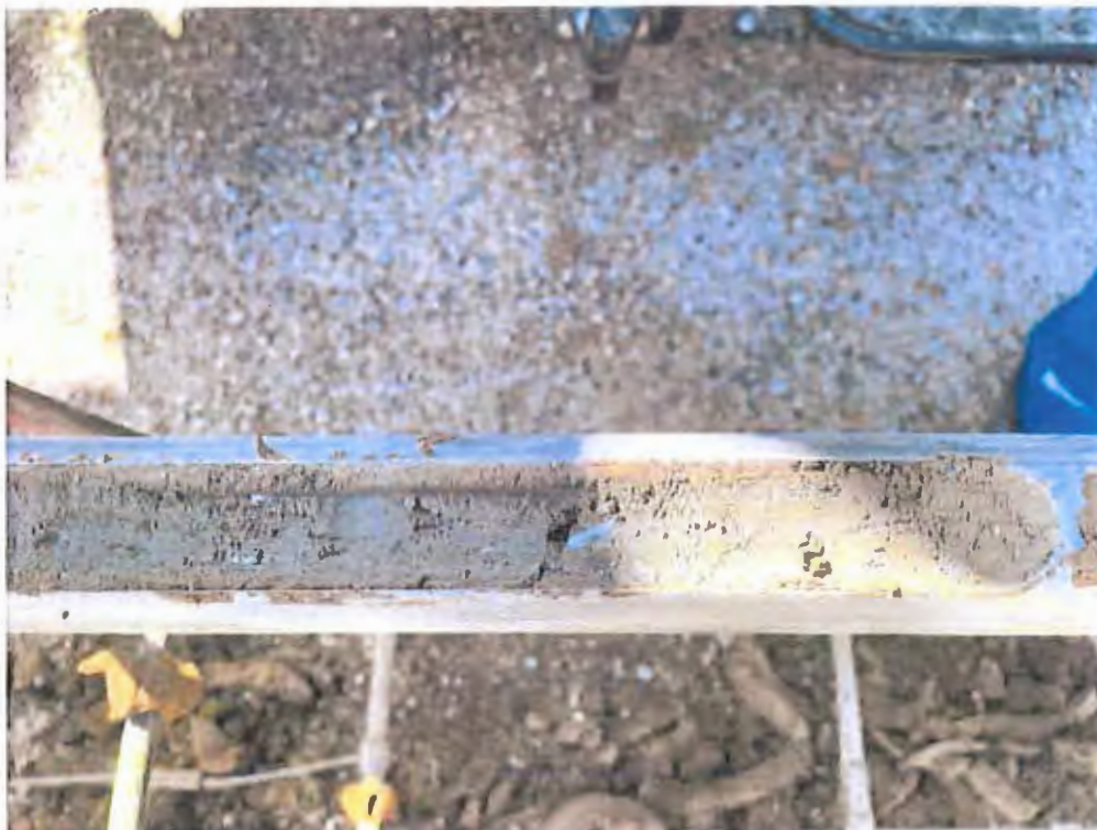
Abb. 7: Erbohrter Geschiebemergel (BS 07 – etwa 3,4m)
