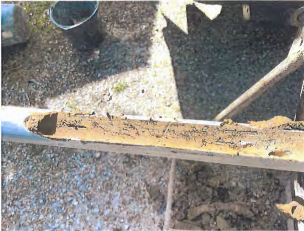
Abb. 6: Erbohrter Geschiebelehm (BS 07 – etwa 2,2m)
